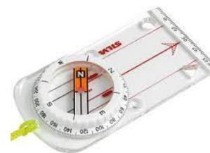
Placer alors horizontalement la boussole devant soi et pivoter sur soi-même de façon à faire coïncider l'aiguille aimantée (bout rouge) avec la « maison » du nord (flèche rouge imprimée sur le cadran de la boussole). Suivre alors la direction indiquée par la flèche de direction en prenant soin de garder l'aiguille aimantée « dans sa maison ». Choisir un point de repère au loin dans la direction indiquée par la flèche de direction pour éviter des écarts.
